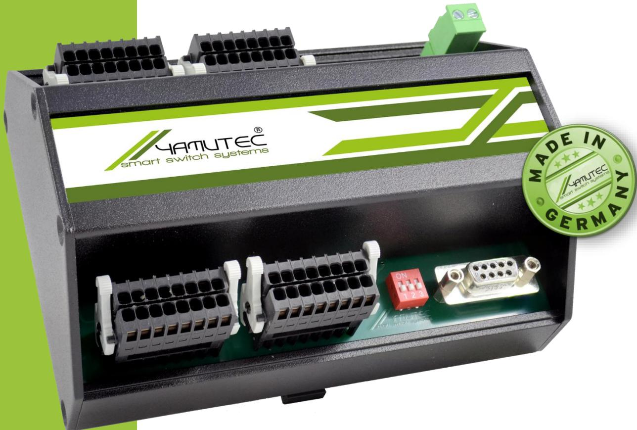
Das Yamutec® SER-REL32 Modul verfügt über 32 potentialfreien Reed Relais Ausgänge. Die Ausgangsrelais bewältigen einen Schaltstrom von bis zu 1A. Dieser sorgen für eine optimale galvanische Trennung von Steuer- und Regelkreis sowie eine zuverlässige Signalübertragung.
